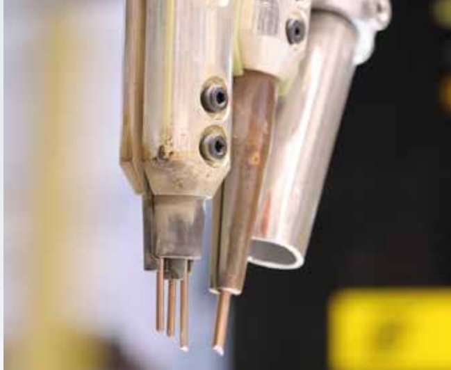
Технология ICE™ - Дополнительный "холодный" электрод
